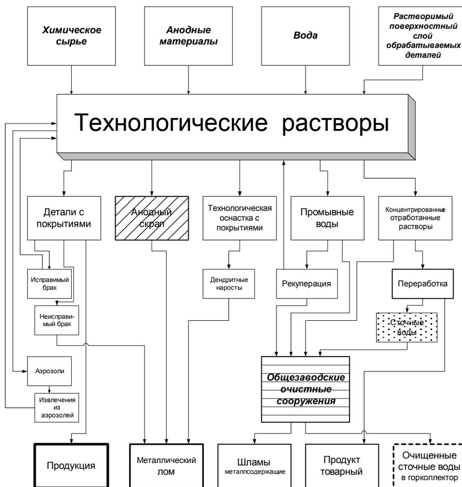
**Схема материальных потоков в гальваническом производстве**
